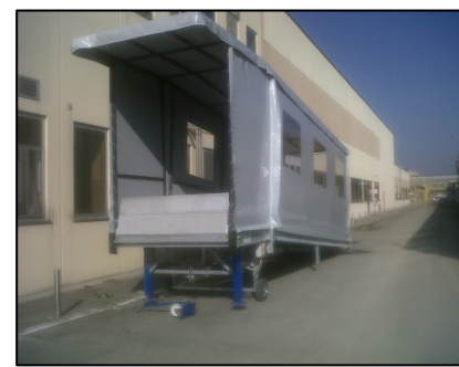
Tunnel di copertura in PVC
